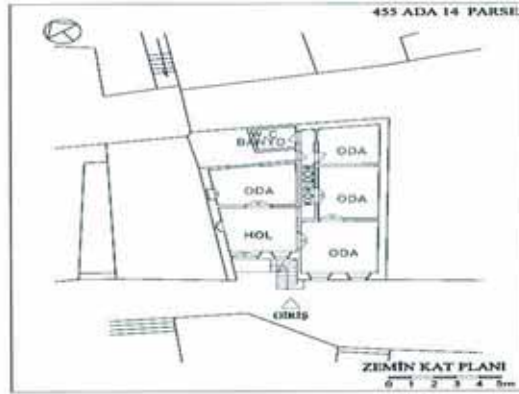
Şek. 11. Hol+koridorlu plan şemasına sahip bir evin (env. no: J18.B5.26) zemin kat planı.
